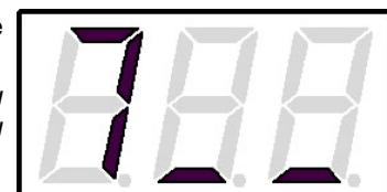
Рис. 8. Символ таймера (дозатора) с отключением тока
