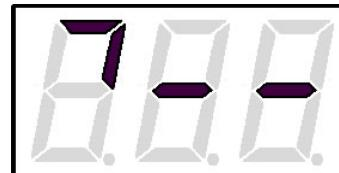
Рис. 9. Символ таймера (дозатора) снижения лимита тока до 10%
