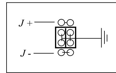
Рис. 14 Снятие заземления с выходных клемм источника
