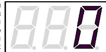
Рис. 7. Символ секундомера (дневного счетчика с прямым счетом)
