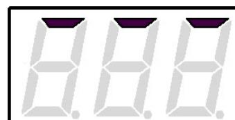
Рис. 10. Символ таймера (дозатора) без отключения тока
